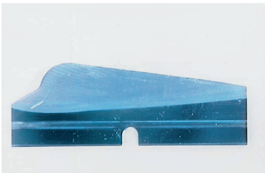
Snijkant afronding door onjuist onderhoud.
